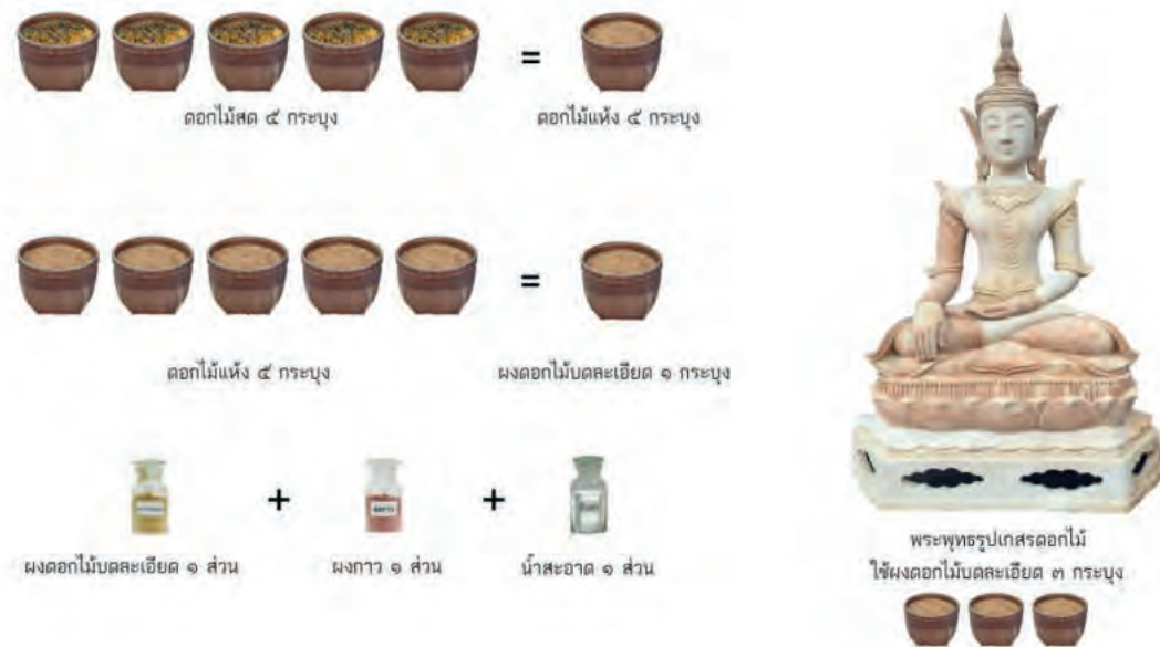
ภาพที่ 9 การกำหนดอัตราส่วนของมวลสารที่ใช้ในการหล่อพระพุทธรูปเกสรดอกไม้
