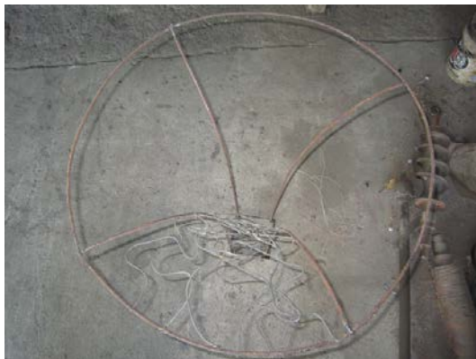
ภาพที่ 6 แสดงโครงสร้างด้านบนของแบบจำลอง โดยใช้เหล็กเส้น และลวด มัด ยึดติดกัน ที่มา: ผู้วิจัย
