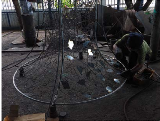
ภาพที่ 8 ขั้นตอนการดำเนินงาน การเชื่อมติดส่วนประกอบต่าง ๆ ของรูปทรง โดยเริ่มจากด้านใน ที่มา: ผู้วิจัย
