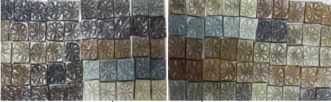
ภาพที่ 4 เคลือบใสและเคลือบทึบที่เติมสารให้สี
