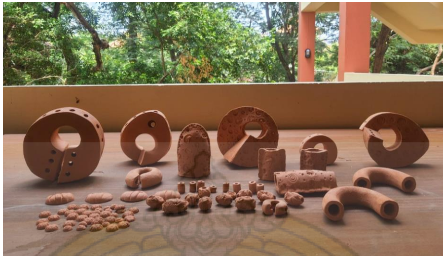
ภาพที่ 41 ภาพชิ้นงานหลังผ่านการเผา เนื้อดินมีความแกร่ง และมีสีเข้มขึ้นจากตอนก่อนเผา ที่มา: (ภาพโดย นางสาวทัศนีย์ รุ่งทวีชัย เมื่อ 14 กุมภาพันธ์ 2565)
