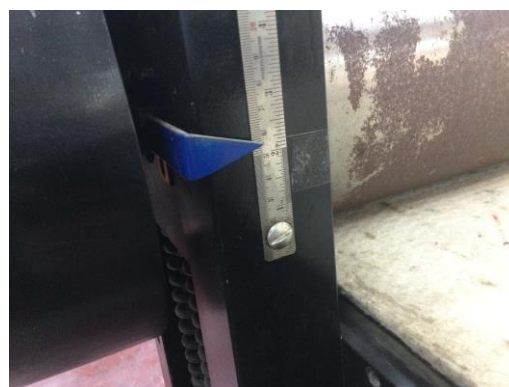
(6) ตรวจสอบระดับแรงกดของแท่นพิมพ์
