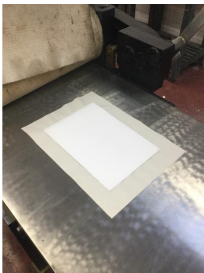
(3) นำกระดาษพิมพ์ที่มีความขึ้นมาวางทับบนเพลทงาน
