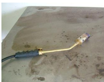
3. ที่ลนความร้อนแม่พิมพ์ยางสน
