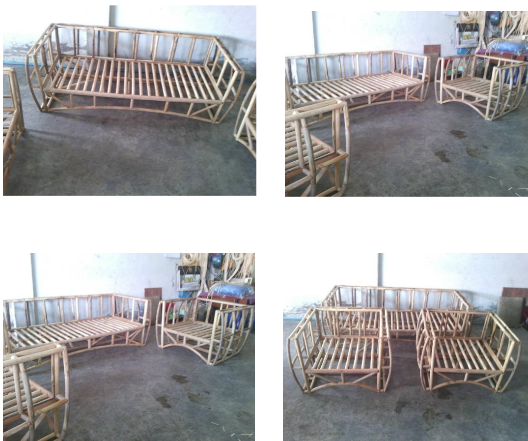
ภาพที่ 4.3 การขึ้นโครงสร้างจากไม้หวาย
